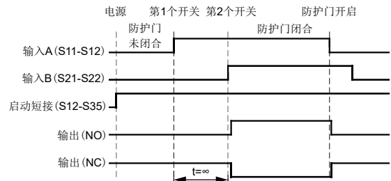
带有自动启动的安全防护门监控功能逻辑时序图
